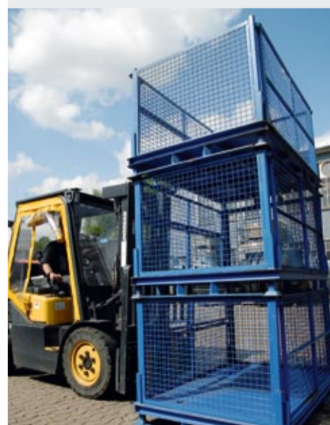
Die Gitterbox in der Kommissionierung / Weiterverarbeitung als Zwischenlager.
