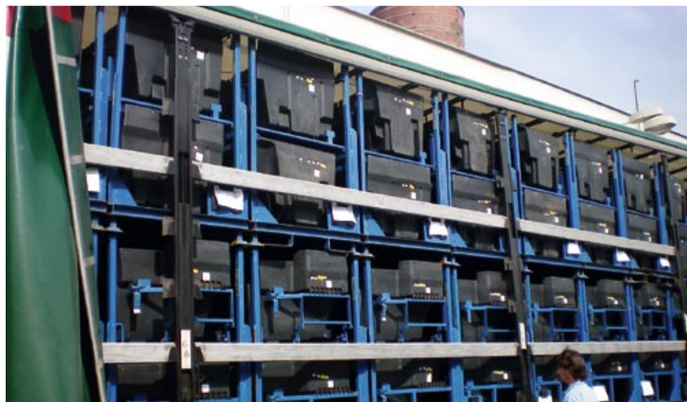
Ladungsträger sorgen für eine optimale Ausnutzung des Ladevolumens und erhöhten Produktschutz.
