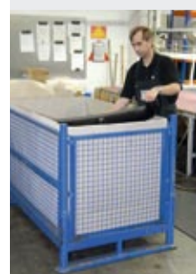
Die Gitterbox in der Kommissionierung / Weiterverarbeitung als Zwischenlager.
